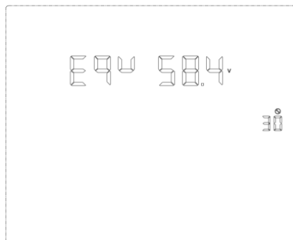
Рис. 1-46. Страница настройки напряжения выравнивающей зарядки
