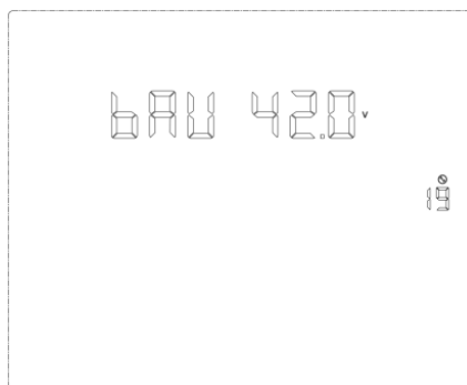
Рис. 1-35. Страница настройки значения напряжения отключения ВБМ HS45-LFP-5K
