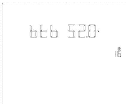
Рис. 1-32. Настройка напряжения ВБМ HS45-LFP-5K для возврата на ВБМ HS45-LFP-5K с электросети
