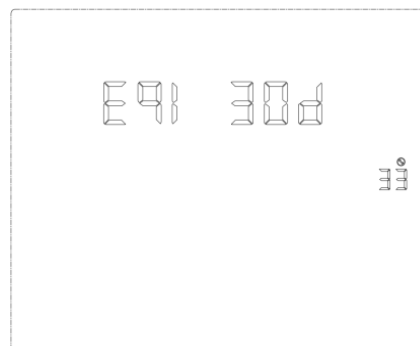
Рис. 1-49. Настройка интервала выравнивающей зарядки
