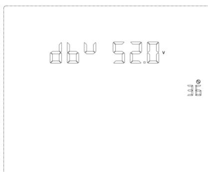
Рис. 1-51. Страница задания напряжения для отключения двойного режима работы БМ HS45-LFP-5K
