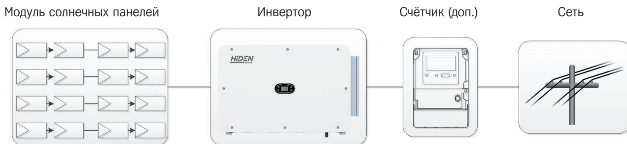
Рис. 2.1. Применение сетевого солнечного инвертора
